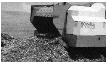
Particolare della FORSU e dei materiali ligneocellulosici dopo la biotriturazione.
